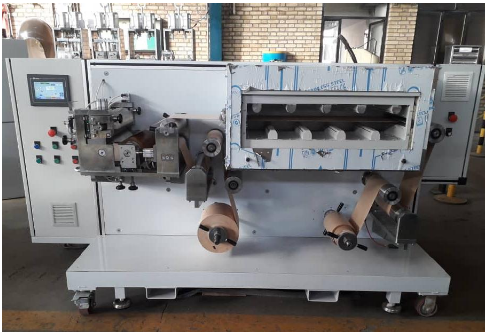
شکل ۱. دستگاه پوشش دهی رول به رول باتری های لیتیوم-یون
