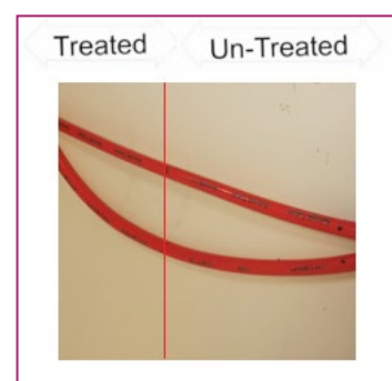
▲ بهبود چاپ پذیری سیم های پی وی سی تحت پردازش پلاسمای، سمت راست) پردازش نشده، سمت چپ) پردازش شده. پاک شدن عبارت چاپ شده Kavosh Yaran از روی سیم در بخش پردازش نشده مشهود است حال آنکه چاپ انجام شده بر بخش پردازش شده با پلاسمای کاملاً مستحکم است.
