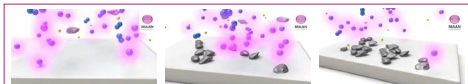
► بمباران سطح در حضور پلازما و تمیز شدن سطح آن
