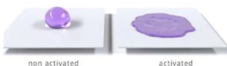
◀ تفاوت انرژی سطحی برای سطح فعال شده با پلازما در مقایسه با سطح بدون پردازش
