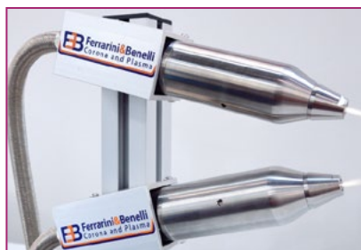
دستگاه PLASMA 3D تreatment ساخت شرکت Ferrarini & Benelli
