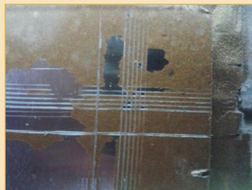
▲ بهبود رنگ پذیری آلومینیوم تحت پردازش پلاسمای جت پلاسمای سرد اتمسفری، سمت راست) پردازش نشده، سمت چپ) پردازش شده. کندگی رنگ تحت آزمون Cross Cut از سطح پردازش نشده مشهود است در صورتیکه رنگ بر روی سطح پردازش شده با پلاسمای چسبندگی بالایی را نشان می دهد.
