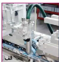
▲ استفاده از پلاسمای سرد (الف) در افزایش چسبندگی چسب بر کارتن در شرکت BOBST (ب) استفاده از پلاسما در چسباندن روکش ها و جعبه های دارای روکش و پلاستیکی
