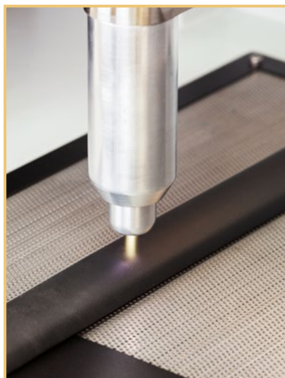
▲ تصاویری از دستگاه جت پلاسمای سرد اتمسفری (ACPJ-16 AR) ساخت شرکت کاوش یاران فن پویا
