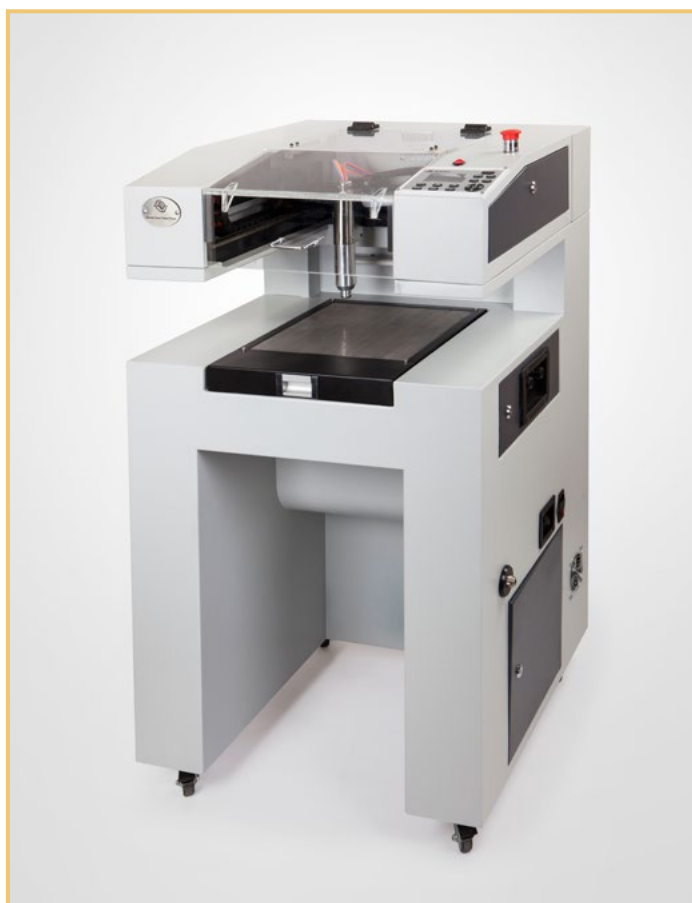
▲ تصاویری از دستگاه جت پلاسمای سرد اتمسفری (ACPJ-16 AR) ساخت شرکت کاوش یاران فن پویا
