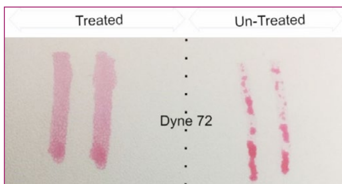
▲ افزایش انرژی سطحی یک سطح پلیمری تحت پردازش پلاسمای جت پلاسمای سرد اتمسفری؛ سمت راست) پردازش نشده، سمت چپ) پردازش شده با پلاسمای.
