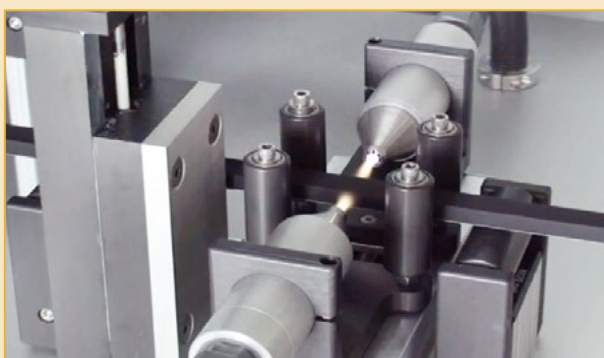
▲ استفاده از پلاسمای سرد در پردازش نوارهای لاستیکی توسط شرکت 3DT
