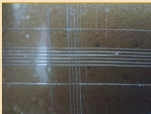
▲ بهبود رنگ پذیری آلومینیوم تحت پردازش پلاسمای جت پلاسمای سرد اتمسفری، سمت راست) پردازش نشده، سمت چپ) پردازش شده. کندگی رنگ تحت آزمون Cross Cut از سطح پردازش نشده مشهود است در صورتیکه رنگ بر روی سطح پردازش شده با پلاسمای چسبندگی بالایی را نشان می دهد.
